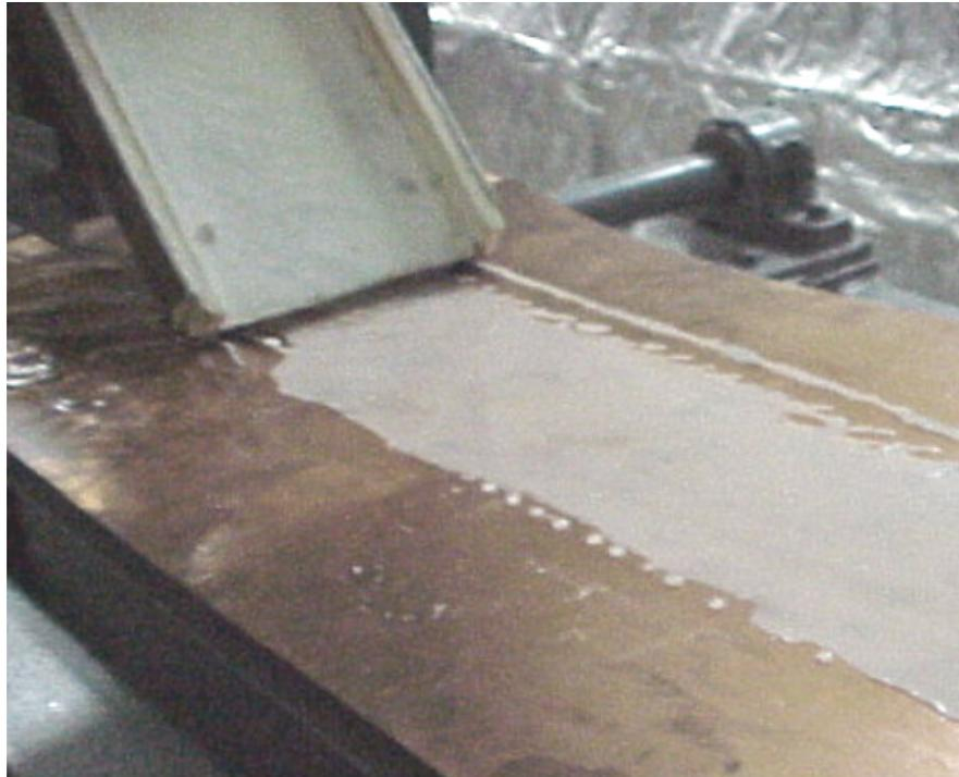
Figura 7 - Lingotamento de parafina pelo processo de cinto único utilizando parafina para simular o metal líquido.
