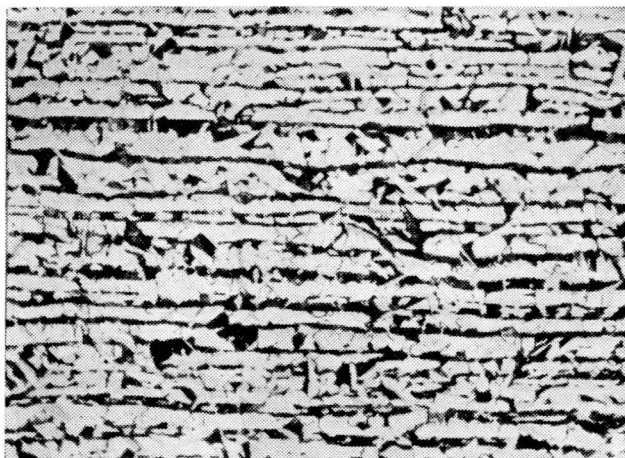
Fig. 1 — Estrutura alinhada com os constituintes ferrita e perlita. Aumento de 100 X. Ataque com nital a 5%.
