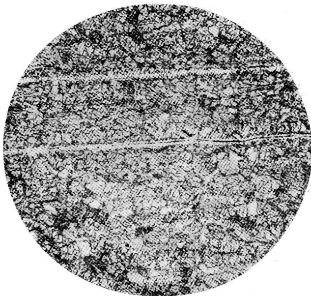
Fig. 21 — Austenitização a 860°C, seguida de têmpera em água e revenido a 650°C. Aumento de 100 ×. Ataque com nital a 5%.
