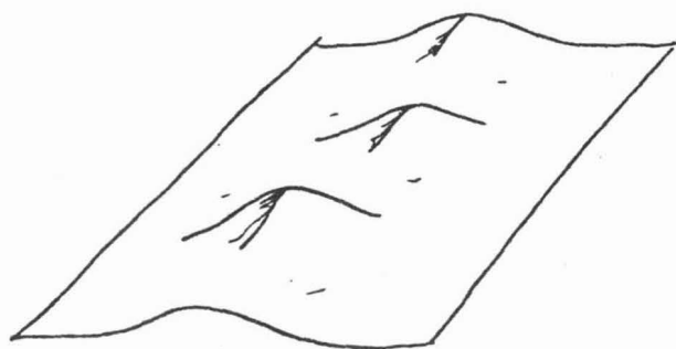
FIGURA 6 - Aparência típica do defeito de aplainamento conhecido na CSN como repuxado.
