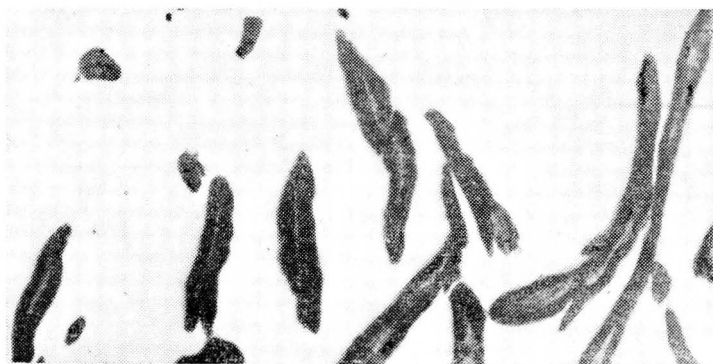
Fig. 3 — Ferro fundido 8.283/5; centro da parede da mesma lingoteira. Sem ataque; 100 ×.
