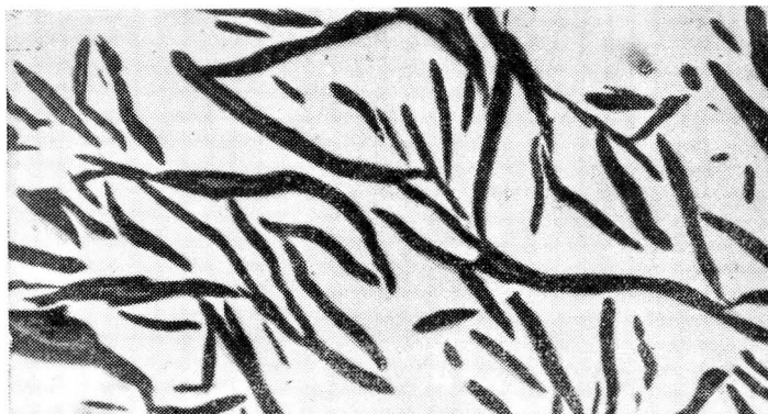
Fig. 2 — Ferro fundido 8.283/1; sub-superfície da lingoteira. Sem ataque; 100 ×.
