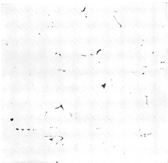
Fig. 19 — Aspecto da cementita terciária no corpo de prova n.º 5 da amostra de chapa fina a frio n.º 4. Ataque com picrato de sódio. Aumento. 250 ×.
