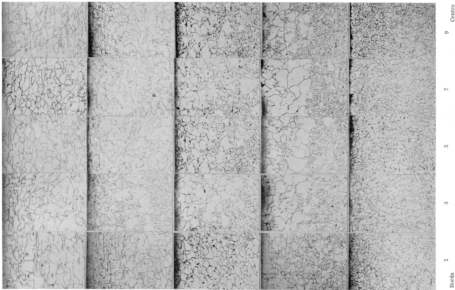
Fig. 12 — Aspecto da estrutura da parte superficial (as fotos abrangem um pouco menos de 1/6 da espessura) de chapas finas a quente acabadas em diferentes temperaturas). Os números 1, 3, 5, 7 e 9 correspondem aos corpos de prova longitudinais que foram recortados desde a borda até o centro da tira. Ataque c/ nital a 5%. Aumento de 100 ×.
