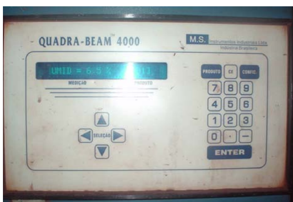
Figura 5. Painel do medidor de umidade.
