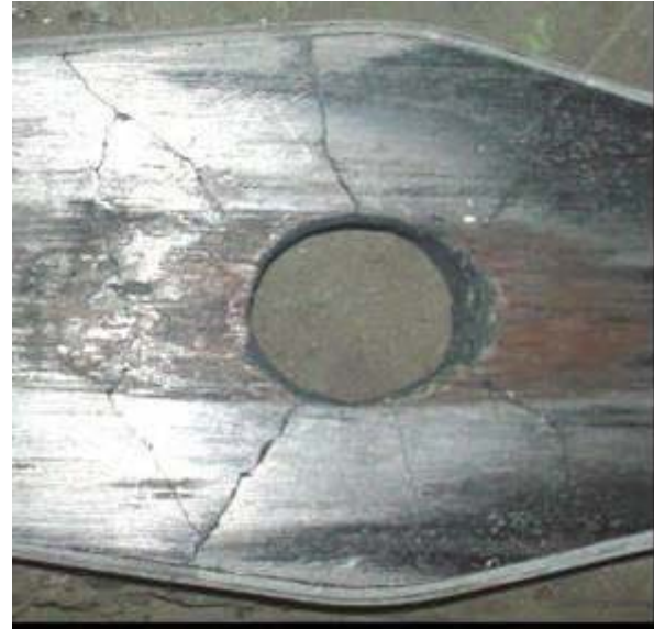
Figura 2. Placas retiradas con seis coladas, en las cuales se observa la aparición de grietas radiales, con origen en el orificio.
