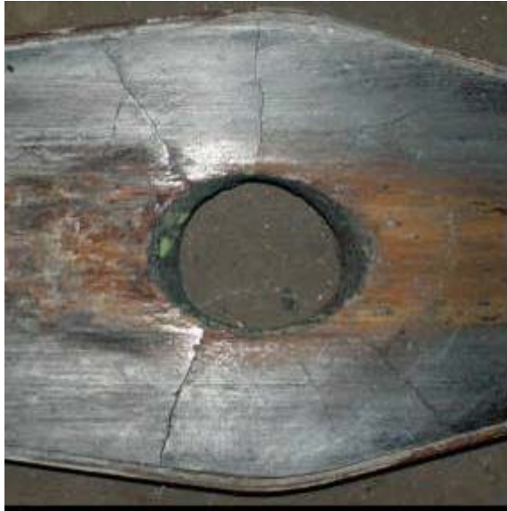
Figura 2. Placas retiradas con seis coladas, en las cuales se observa la aparición de grietas radiales, con origen en el orificio.
