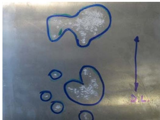
Figura 4 – Amostra de defeito “marca de deslizamento”.
