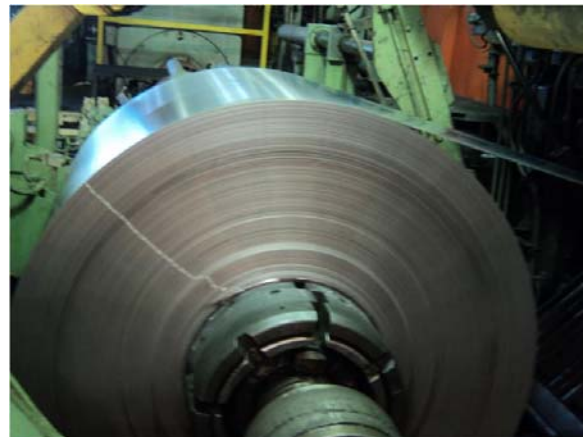
Figura 3 – Deslocamento longitudinal das espiras.
