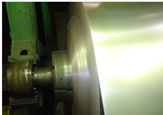
Figura 1 – Deslocamento de espiras com a formação de “bacia”.
