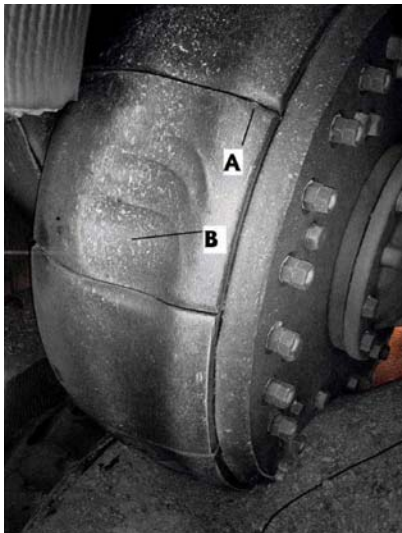
Figura 1. Rolo pulverizador de ferro fundido branco com desgaste brando nas interseções (A) e desgaste mais intenso nas áreas do segmento (B) a espera da solda de revestimento(1).
