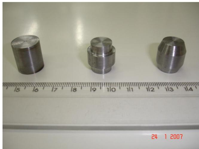
**Figura 5.** Corpos de prova submetidas ao teste de compressão
