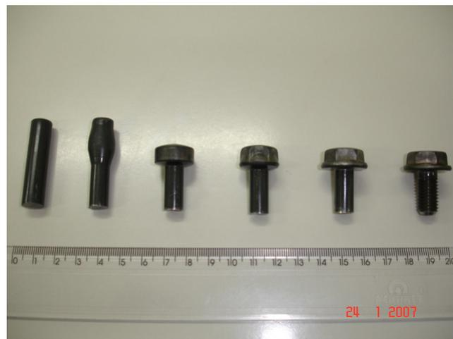
**Figura 1.** Seqüência de deformação de parafuso
