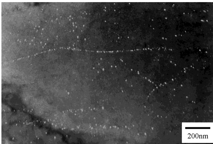
Figura 2: Micrografia MET em campo escuro gerada por difração de elétrons provenientes de carbonitreto formado sobre os antigos contornos de subgrão da austenita. Amostra em lâmina fina. Aumento nominal: 70.000 vezes.
