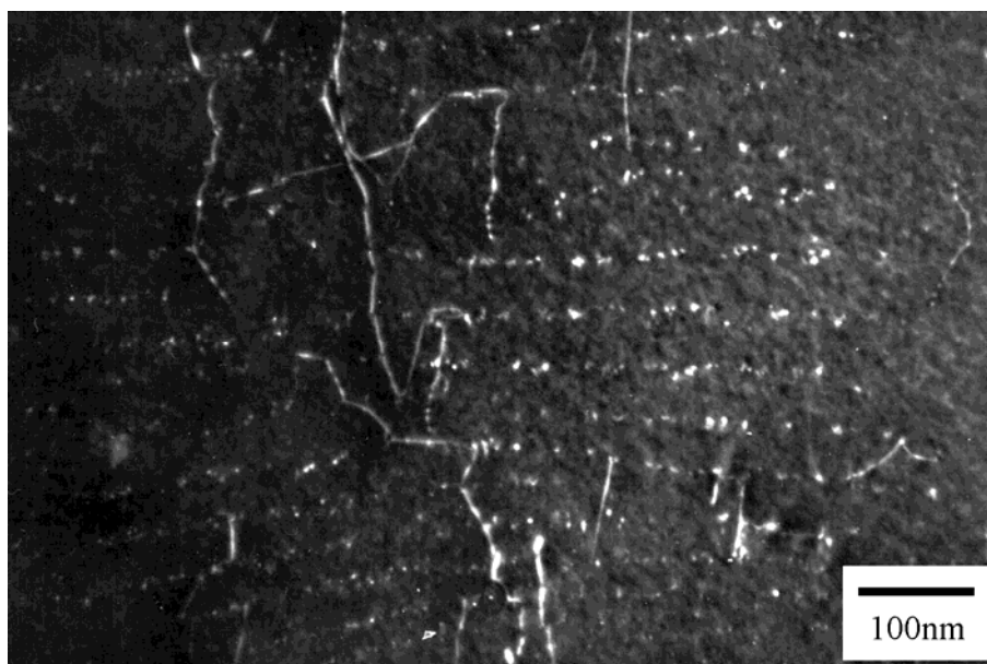
Figura 3: Micrografia MET em campo escuro mostrando parte de um grão ferrítico com precipitação interfásica e discordâncias, mostrando os carbonitreto alinhados em fileiras. Amostra em lâmina fina. Aumento nominal: 140.000 vezes.
