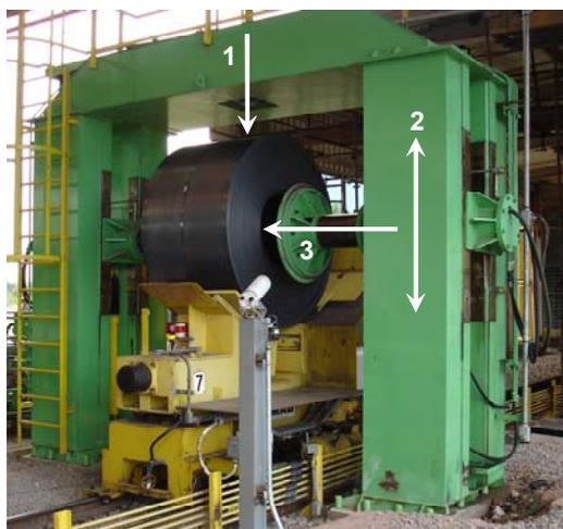
Figura 4. 1 - Detecção do diâmetro da bobina; 2 - Ajuste vertical dos discos de correção; 3 - Movimento horizontal dos discos para correção da telescopicidade.
