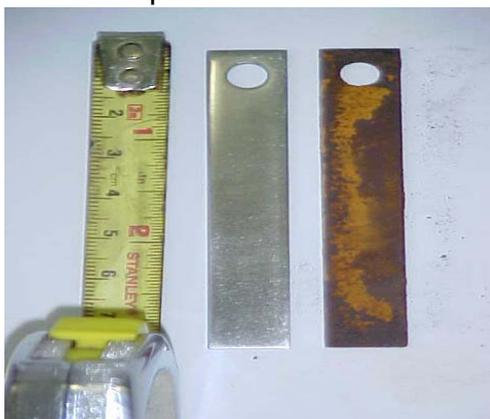
**Figura 1.** Aspecto as superfície do corpo de prova de aço carbono antes e depois de exposição.
