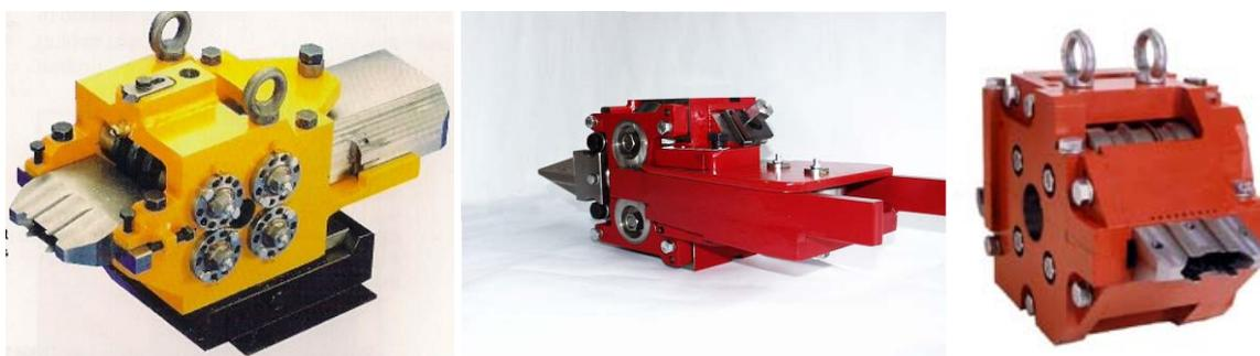
Figura 10. A evolução da guia multi slitter MSL (*Multi Strand Slitter*).
