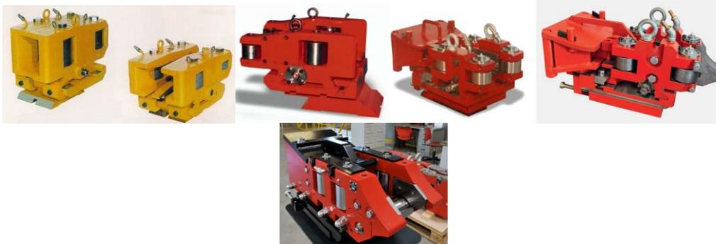
**Figura 14.** A evolução da guia PRD (Profile Roller Double)
