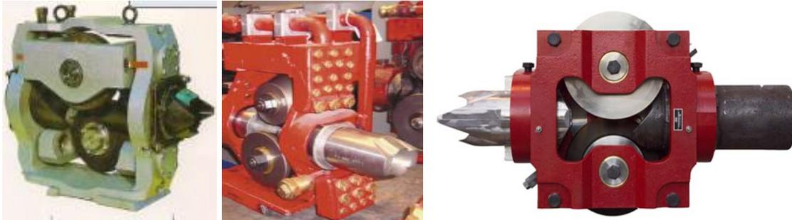
Figura 8. A evolução das guias de torção RTC (*Cassetta Torsione Rulli*)
