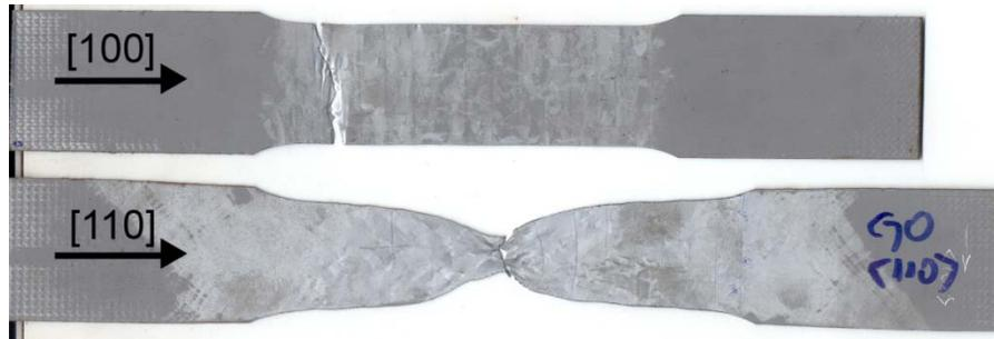
**Figura 4:** corpos de prova tracionados em [100] e [110]
