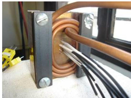
Figura 3. Disposición de las placas de cobre y acero unido al sistema de refrigeración del equipo de transferencia térmica.
