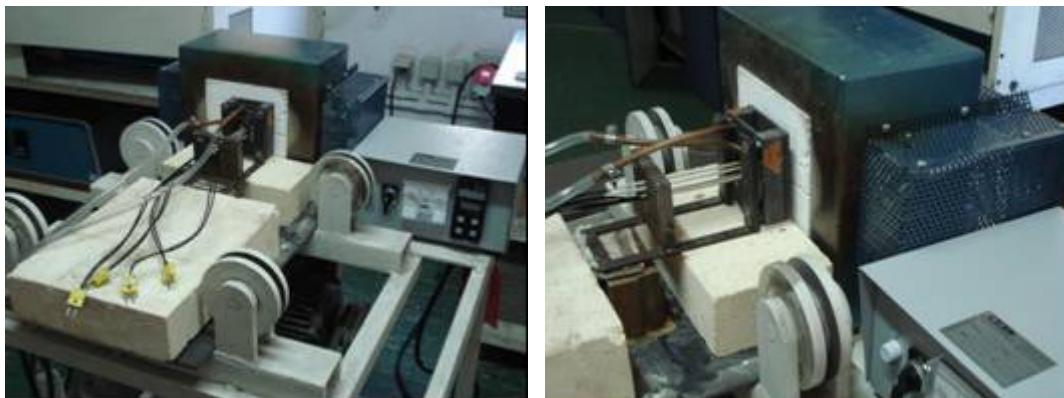
Figura 5. Dispositivo armado con la pantalla calefactora y el controlador de potencia en etapa experimental.
