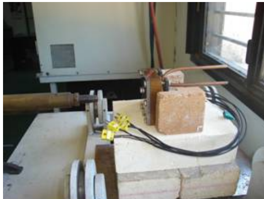
Figura 4. Montaje previo al ensayo y distribución de las termocuplas en las distintas zonas de registro.
