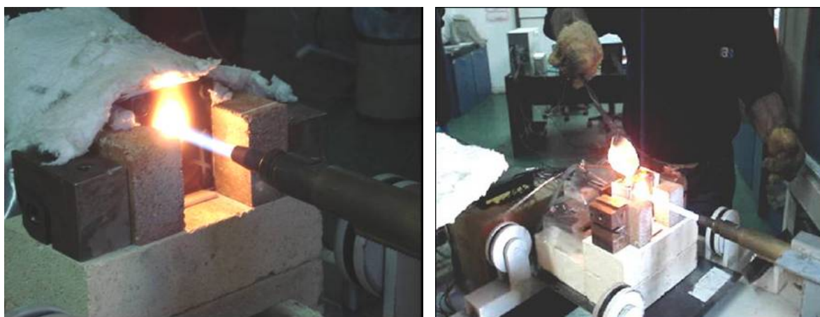
(a) (b) Figura 6. Etapa de calentamiento y vuelco del polvo.
