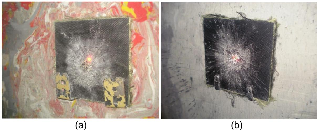
**Figura 6.** Aspecto geral dos SBMs após o impacto balístico: (a) SBM com cerâmica plana; (b) SBM com cerâmica convexa.
