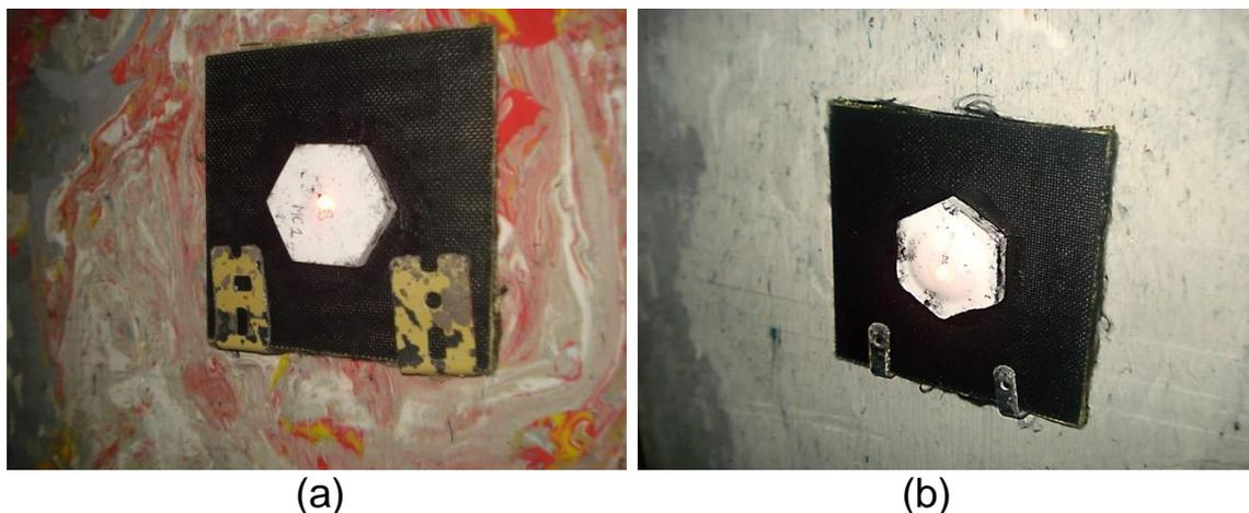
**Figura 5.** SBMs fixados na plastilina para ensaio balístico, com camada intermediária de compósito de (a) fibra de rami e (b) tecido de aramida.
