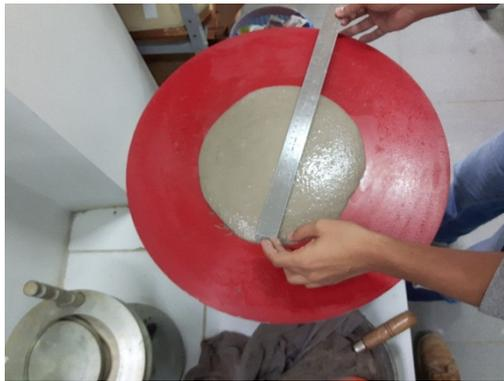
**Figura 2.** Ensaio de determinação do índice de consistência normal da argamassa.
