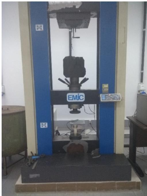
Figura 4. Realização de ensaio de compressão axial em máquina universal Emic DL30000N.
