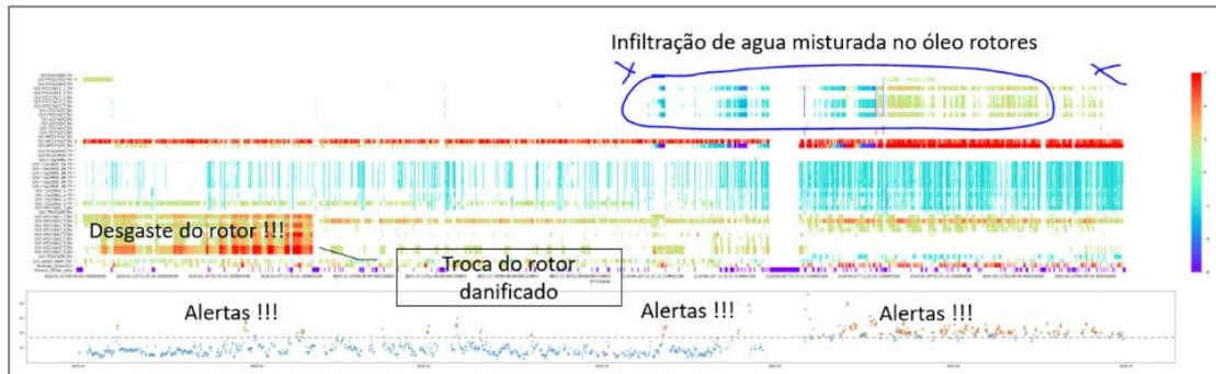
**Figura 3.** Resultados preliminares da detecção de anomalias no equipamento monitorado desenvolvido em plataformas *open-source* Python.
