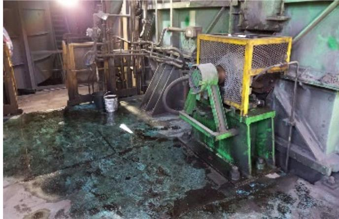
Figura 10. Inspeção em campo evidenciando vazamento de óleo.
