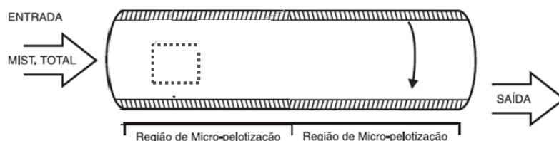
Figura 3. Esquema típico de um nodulizador tambor[3].
