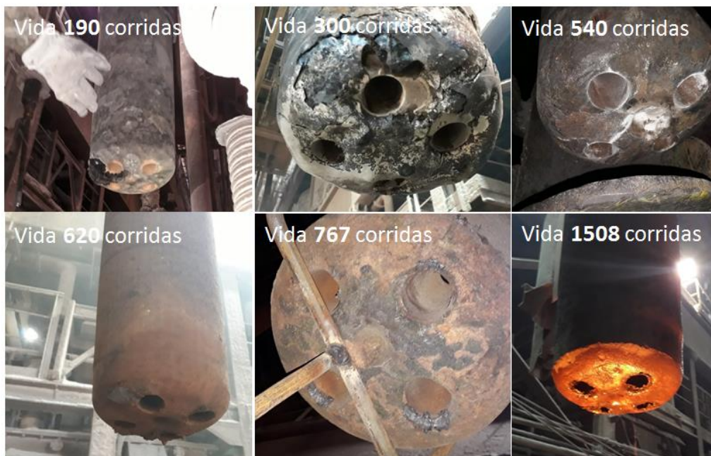
Figura 13 Perfil de desgastes do bico
