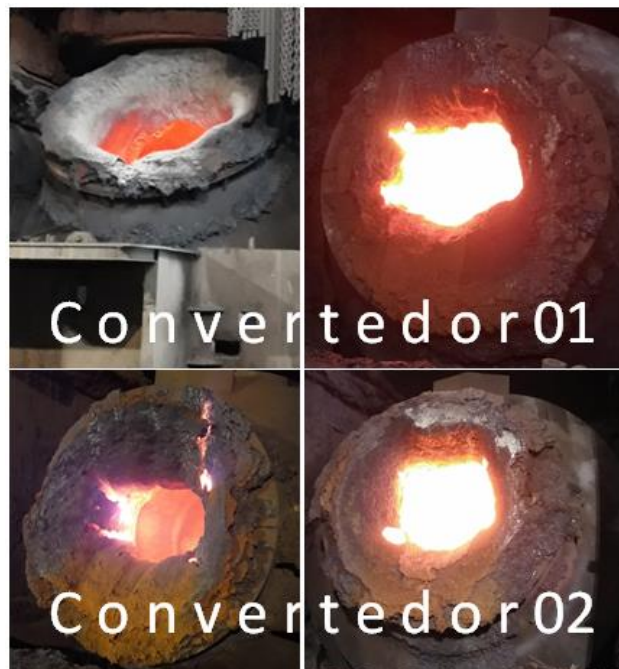
Figura 7 Boca dos convertedores 1 e 2 sem utilização da tecnologia Slagless Clean up®
