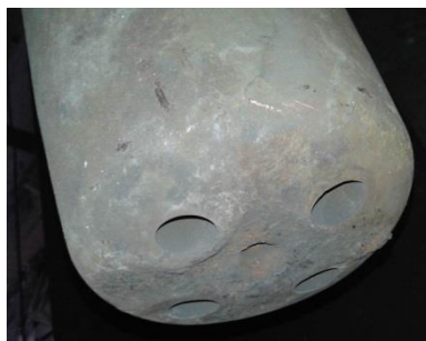
Figura 2 Condições do bico após saída de operação
