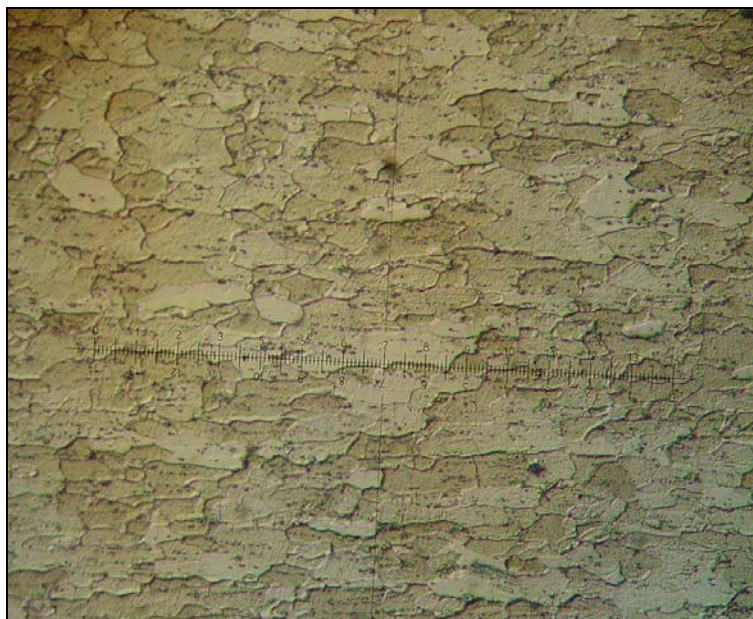
Figura 6 - Microestrutura típica do material H240LA. Aumento: 100X.
