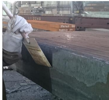
Remoção da carepa.
