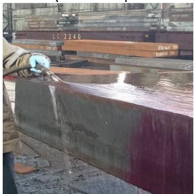
Remoção do Líquido Penetrante.
