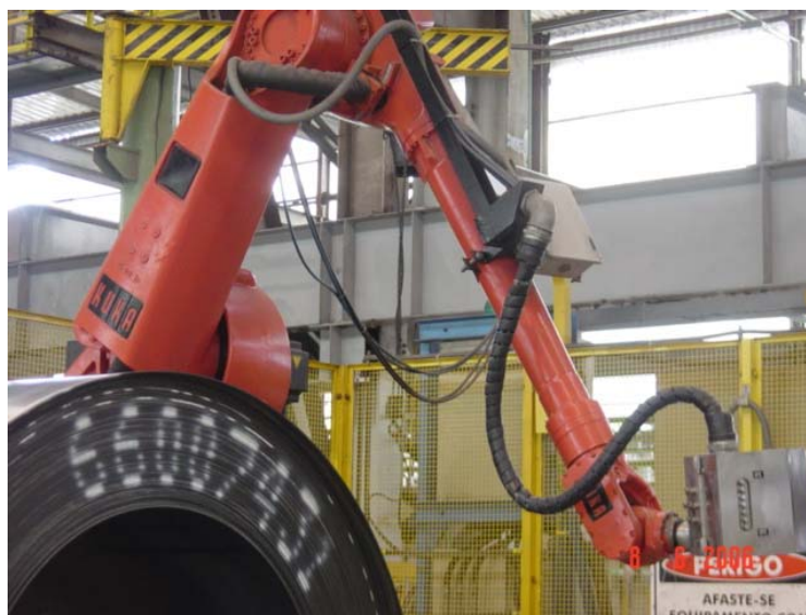
Figura 1. Máquina de marcar automática da saída do Laminador de Acabamento.
