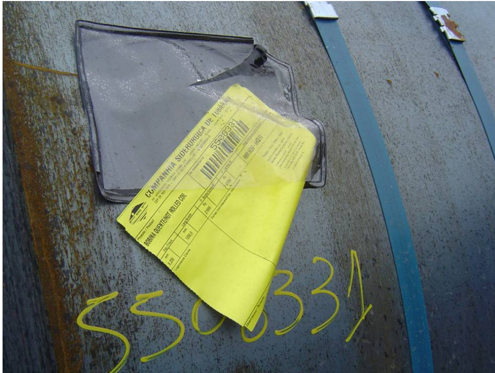
Figura 4. Porta-etiqueta rasgado em bobina estocada no cliente.
