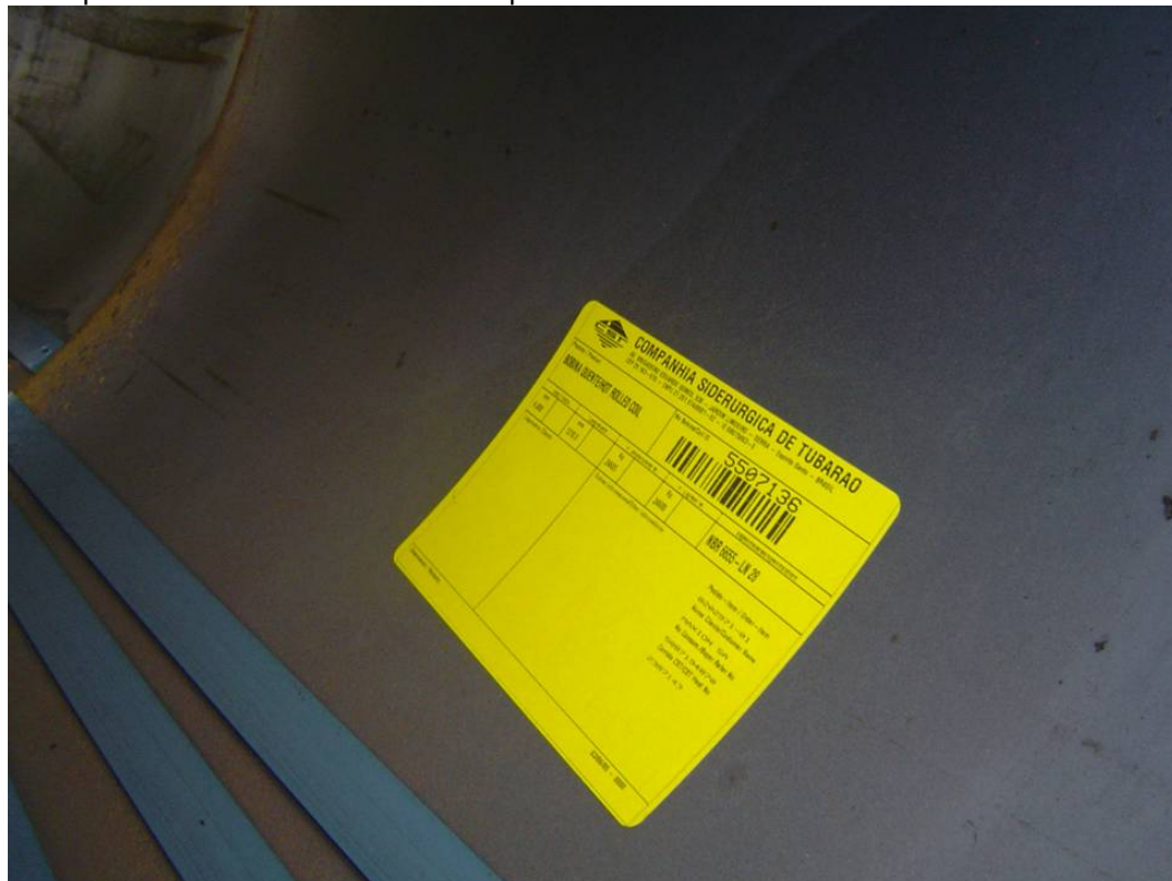
Figura 7. Etiqueta auto-adesiva afixada na espira interna de uma bobina estocada ao ar livre no cliente.
