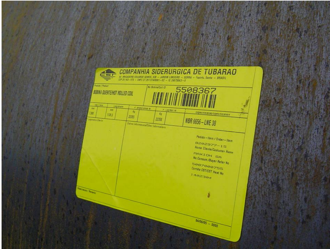
Figura 6. Etiqueta auto-adesiva afixada na espira externa de uma bobina estocada ao ar livre no cliente.
