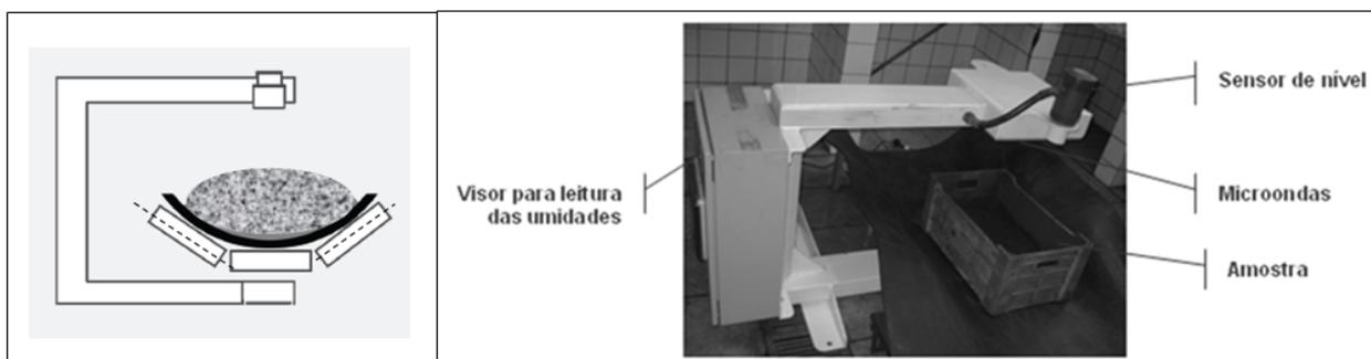
**Figura 2.** Desenho esquemático do analisador/ Foto do equipamento utilizado.
