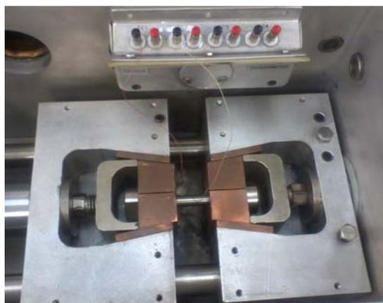
**Figura 2.** Imagem dos corpos de prova ensaiados na Gleeble.
