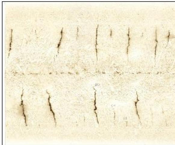
**Figura 1** – Impressão de Baumann do primeiro lote de aço microligado ao boro na CST.
