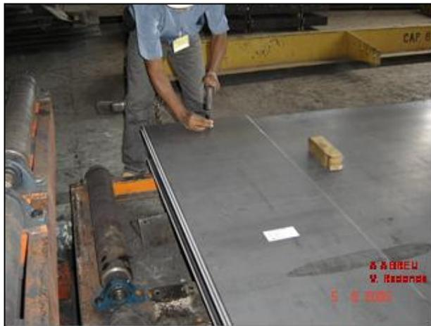
**Figura 4 – Após o corte, identificação das chapas**
