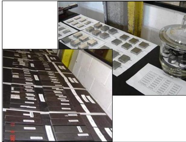
**Figura 5 – Amostras identificadas para ensaios mecânicos**
