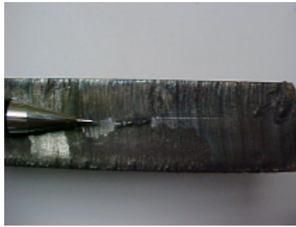
Fig. 05: Amostra de trinca ocasionada por “H”
