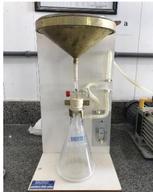
**Figura 5.** Aparelho de retenção de água. a) Prato onde é colocado a papel filtro e posteriormente argamassa.
