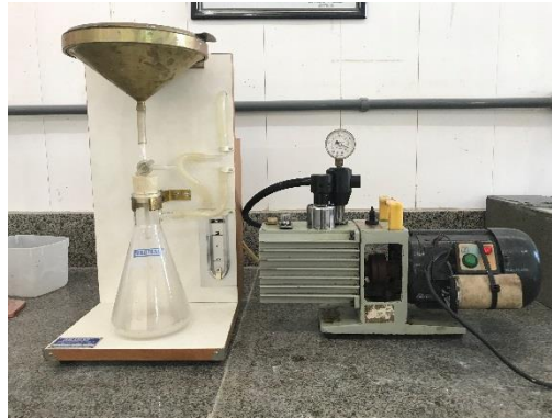
Figura 4. Ensaio da retenção de água.
