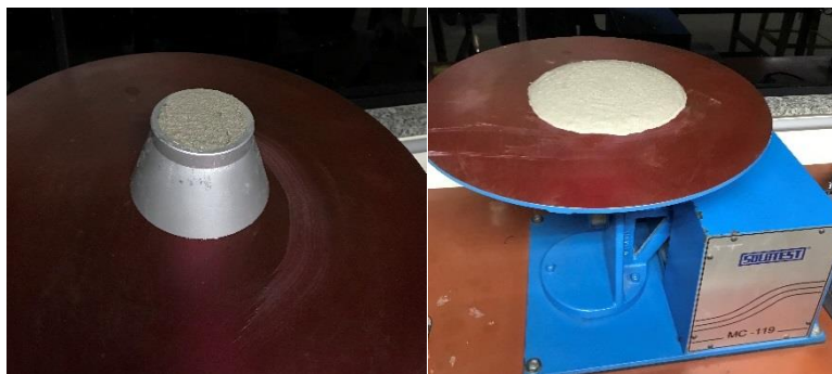
Figura 1. Mesa de consistência com o molde em tronco e argamassa; ensaio de espalhamento da argamassa.
