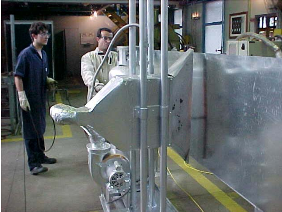
Figura 4 – Sistema de aquecimento por ar quente proveniente de queimador tipo cortina. Potência: 550 Mcal, Combustível: GLP (Cilindro de 45 Kg), Deslocamento: Manual por Rodas, Geração de ar aquecido na faixa de 200 a 500°C.
