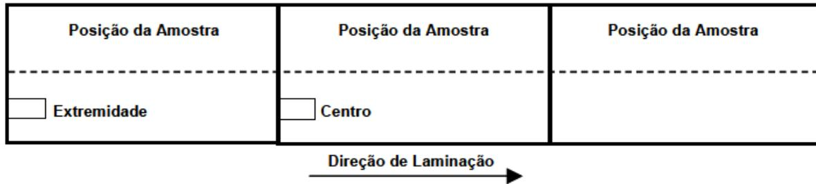
**Figura 8:** Representação esquemática mostrando a posição das amostras no esboço laminado.
