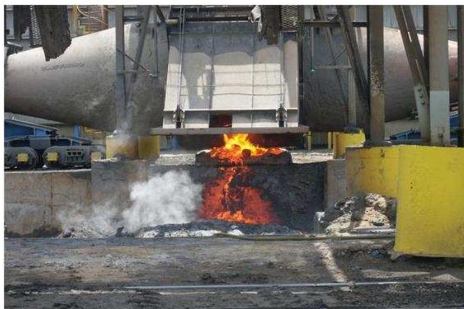
**Figura 5.** Rampa do Kish Pit dos carros torpedo da CSN.
