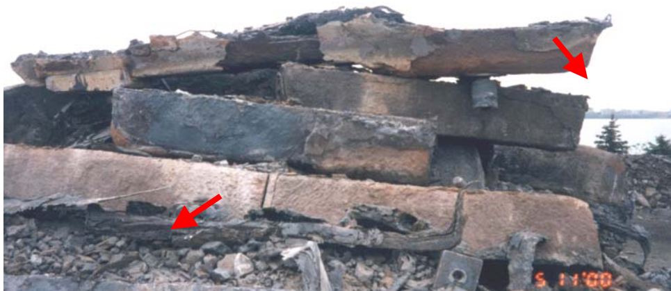
Figura 4. Cascão de aço do distribuidor de aço da Usina Stelco Hilton com redução de 4 t indicado pelas setas.
