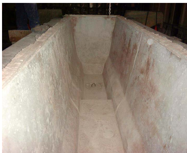
Figura 6. Fotografia da configuração interna do distribuidor de aço com Sistema YES da Usina da Stelco Hilton. Presença do “rodapé” lateral e elevação do fundo na parte central.
