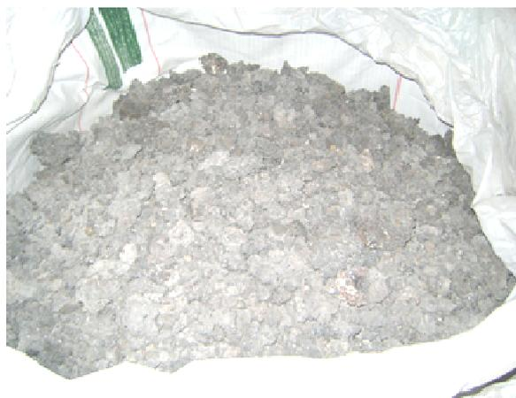
**Figura 2** – Escória sintética sinterizada.
