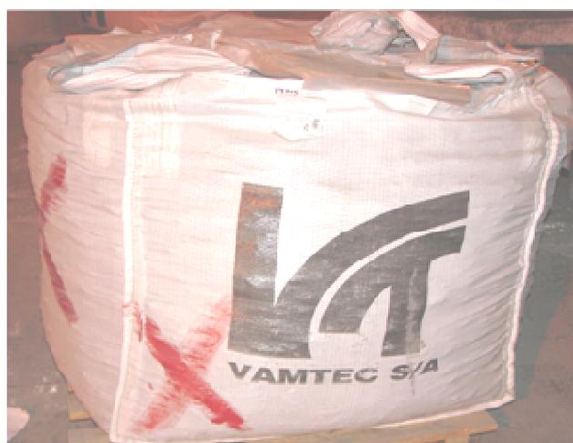
**Figura 3** – Bag de escória sintética sinterizada.
