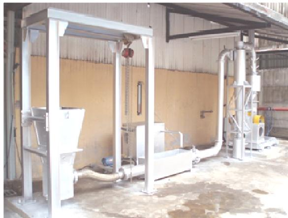
**Figura 1**– Sinterizador piloto do Centro de Pesquisa da Vamtec S.A
