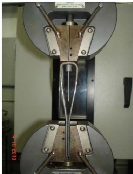
**Figura 3.** Ensaio de tração para verificar a carga de vinculação por EMF.
