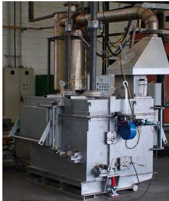
Figura 2. Forno plasma estacionário desenvolvido.
