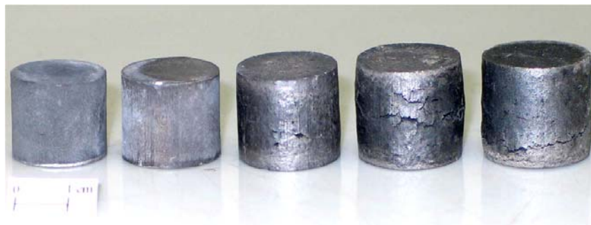
Figura 3 - Amostras de zircônia co-dopada com ítria e nióbia sinterizadas a 1.700°C/1h. Da esquerda para direita: 0%, 5%, 10%, 15% e 20% em peso de nióbia, todos os alvos com 10% em peso de ítria e massa aproximada de 20g.
