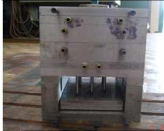
**Figura 13:** Molde projetado e fabricado do protótipo do tijolo.
