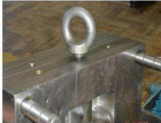
**Figura 15:** Molde fabricado com Olhal da parte fixa.
