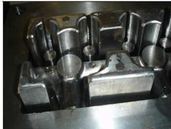
**Figura 12:** Molde projetado e fabricado do protótipo do tijolo.
