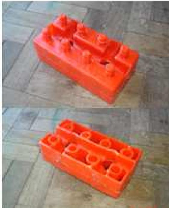
**Figura 17:** Peça injetada.
