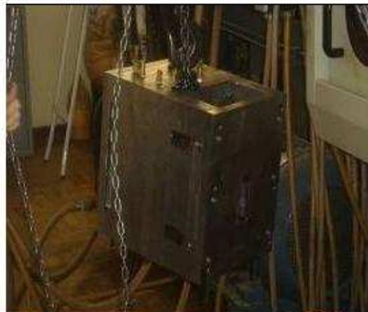
**Figura 14:** Molde fabricado com olhal de sustentação.
