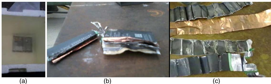
**Figura 2:** (a) Baterias imersas em nitrogênio líquido; (b) Corte longitudinal de uma bateria. (c) papéis separadores (1<sup>o</sup> e 3<sup>o</sup> de acima para baixo), Ânodo (Cu) e Cátodo (Al).
