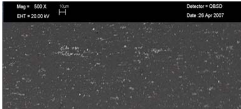
Figura 12. Imagem de microscopia eletrônica de varredura, 500X, Liga 8011, T.T. 280°C/1hora
