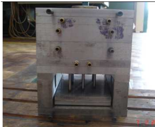
Figura 13: Molde projetado e fabricado do protótipo do tijolo.
