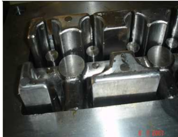
Figura 12: Molde projetado e fabricado do protótipo do tijolo.
