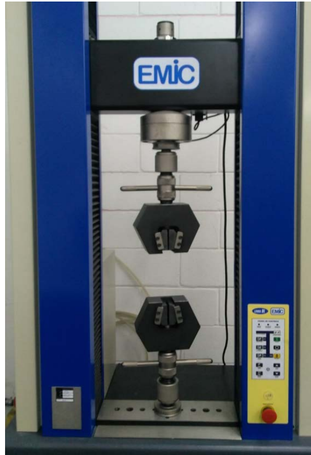
Figura 1. Máquina universal de ensaios mecânicos destrutivos DL 10.000 da UNISANTA.
