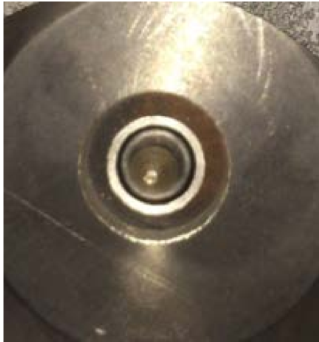
Figura 5. Furo sendo expandido durante o ensaio (CP2) registrado por uma câmera posicionada abaixo do conjunto chapa-contra chapa.
