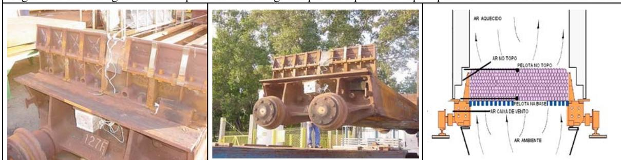
Figura 3.1-2: Detalhes caixa coletora de dados, suportes dos termopares superiores e esquema final em uma lateral do carro
