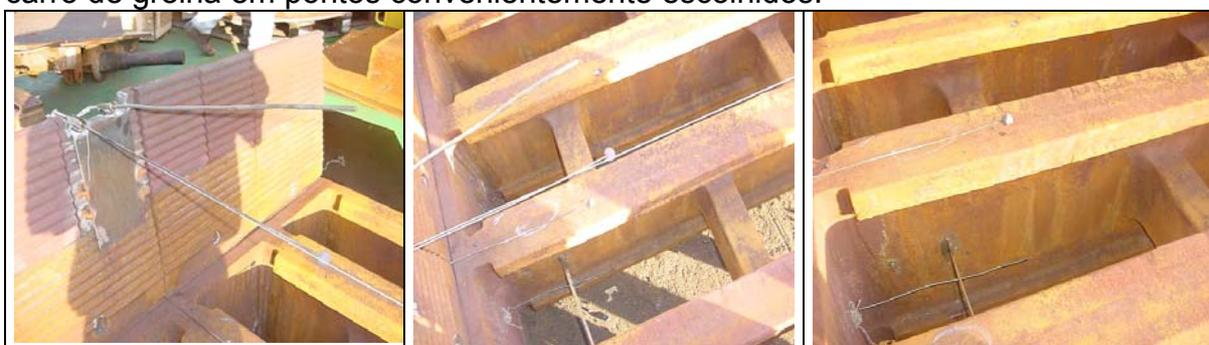
Figura 3.1-1: Montagem dos termopares no carro de grelha para ar e pelota no topo e pelota na base e ar na caixa de vento
