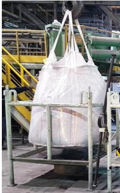
**Figura 1.** *Bigbag* com pó fluxante sendo colocado na estrutura de apoio na área de lingotamento contínuo.
