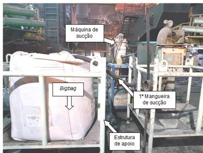
**Figura 2.** Sistema de sucção do pó fluxante, onde se visualiza o *bigbag*, estrutura de apoio, mangueira de sucção e a máquina de sucção.
