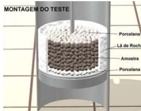
Figura 4. Exemplificação de montagem da amostra no teste ISO11256.
