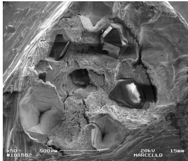
Figura 3. Secção transversal do compósito diamantado. \varnothing=1,84\text{mm} .
