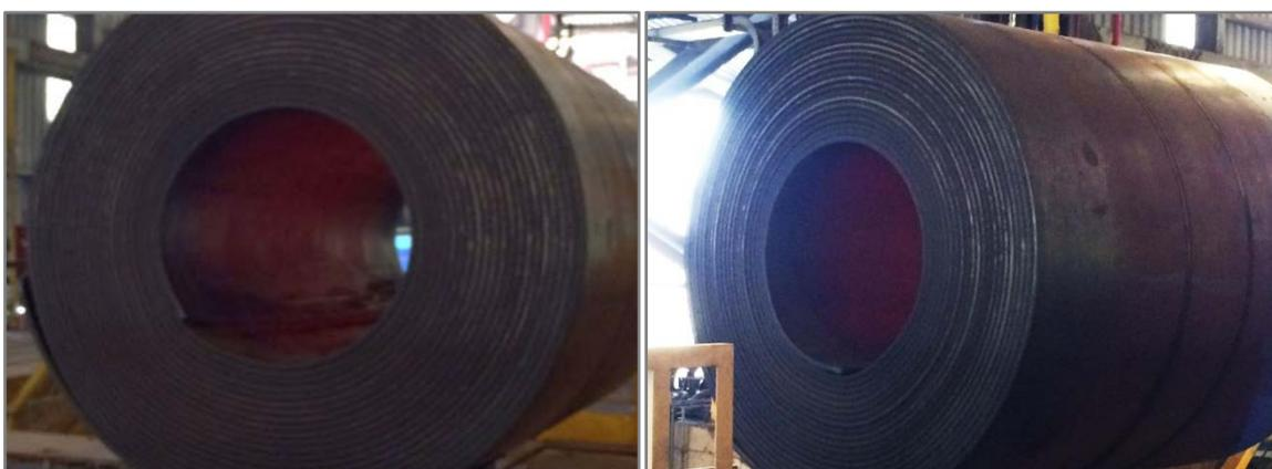
Figura 10. Bobinas teste 22,40x2050mm e 25,4 x 2050 mm (1018-36-2-CV300).
