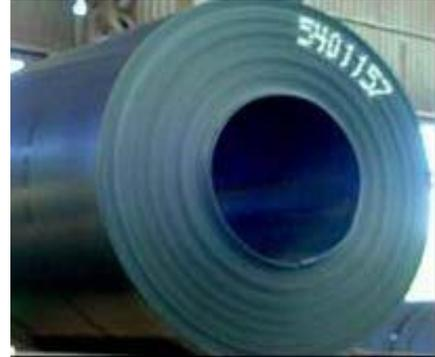
**Figura 9.** Resultado do bobinamento após alteração da tensão unitária.
